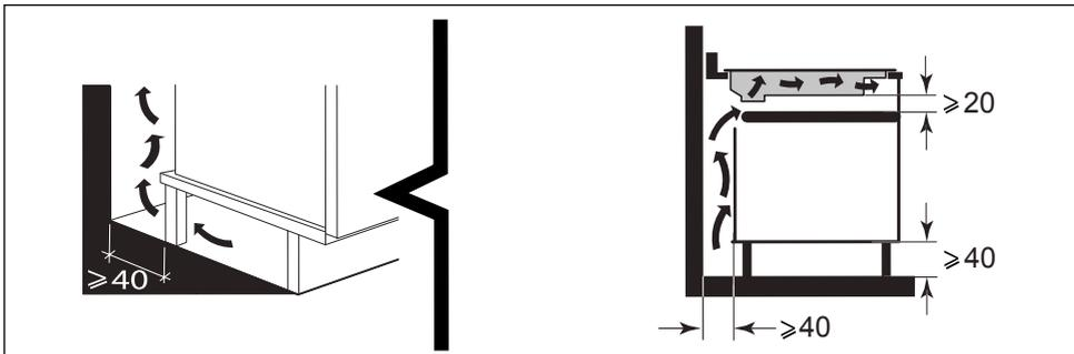
ou au-dessus d'un four encastrable, respectez les dimensions notées sur les illustrations afin d'assurer une sortie d'air suffisante.
