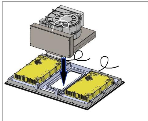
Les crochets métalliques de la hotte filtrante doivent être insérés dans les fentes spécifiques, comme indiqué.
