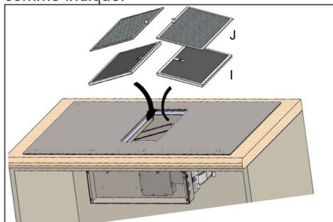
Les filtres à charbon (I) sont situés juste en dessous des filtres à graisse (J), ils doivent donc être installés avant les filtres à graisse. Un kit de canalisation (B) avec grille (G) (à l'extrémité à installer dans le meuble) est fourni avec le produit.
