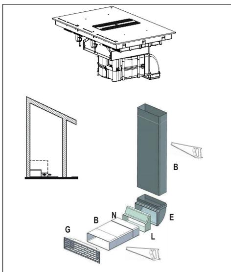
La sortie d'air du produit doit être reliée à l'ouverture du meuble afin de recycler
