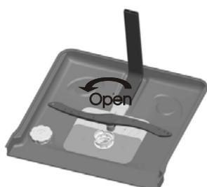
Étape 1 : tournez le filtre dans le sens inverse des aiguilles d'une montre.
