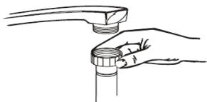
Raccordez le tuyau d'arrivée d'eau froide à un raccord fileté 3/4 et assurez-vous qu'il soit bien serré.
