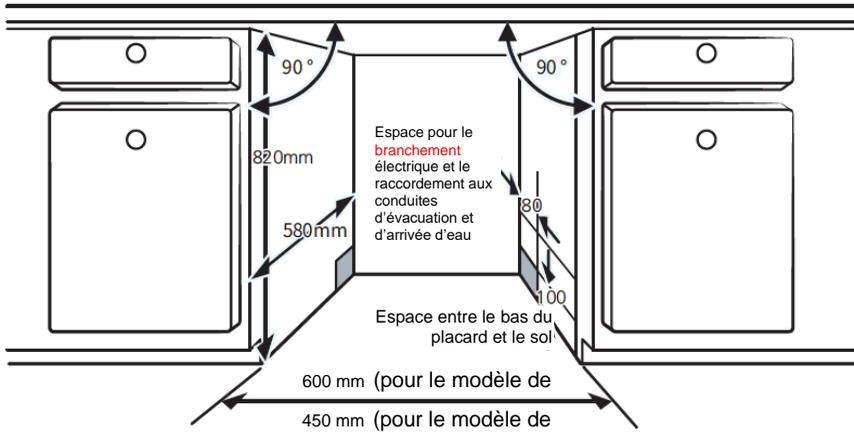
2. Si le lave-vaisselle est installé près d'un angle, prévoyez une distance de sécurité pour l'ouverture de la porte.
