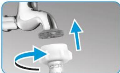
Robinet avec filetage et tuyau d'arrivée d'eau
