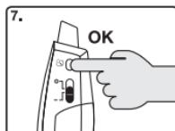
Confermare l'abbinamento premendo il pulsante «Menu» una seconda volta
