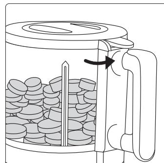
6. Deckel schließen und das Verriegelungssystem (B) zur Verriegelung gegen den Uhrzeigersinn drehen. Der Deckel sitzt fest, wenn das Verriegelungssystem im entsprechenden Schlitz eingerastet ist. Ein „Klick“ zeigt Ihnen an, dass die Mixerschüssel verriegelt und einsatzbereit ist.
