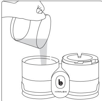
**1.** Gebruik de kom (C) om water in het reservoir (H) te gieten. Met water vullen volgens de op de hulpgids voor de kookfunctie.
