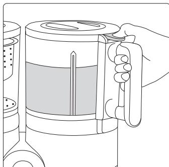
**7.** Stiskněte tlačítko mixování (E). **VAROVÁNÍ:** provádějte lehká a krátká stisknutí tlačítka v délce 5 vteřin maximálně, zamezíte riziku přehřátí.
