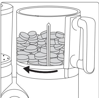
5. Mixerschüssel (C) gegen den Uhrzeigersinn drehen und arretieren.
