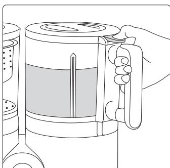
**7.** Carregue no botão de mistura (E) para misturar os alimentos. **ATENÇÃO:** carregue no botão em pequenos intervalos de 5 segundos no máximo, para evitar qualquer risco de sobreaquecimento.
