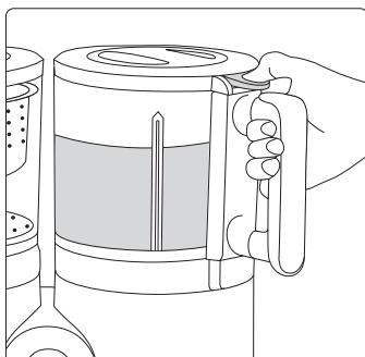
7. Az élelmiszer aprításához nyomja meg az aprítás (turmix) gombot (E). **VIGYÁZAT:** a túlmelegedés elkerülése érdekében csak kicsit nyomja meg és röviden 5 másodpercig a gombot.
