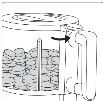
**6.** Fechar a tampa rodando o sistema de fecho (B) sentido anti-horário. A tampa estará correctamente colocada quando o sistema de fecho esteja bem preso no encaixe. Ouvirá um pequeno clique que lhe indicará que o copo misturador está fechado e pronto para ser utilizado.
