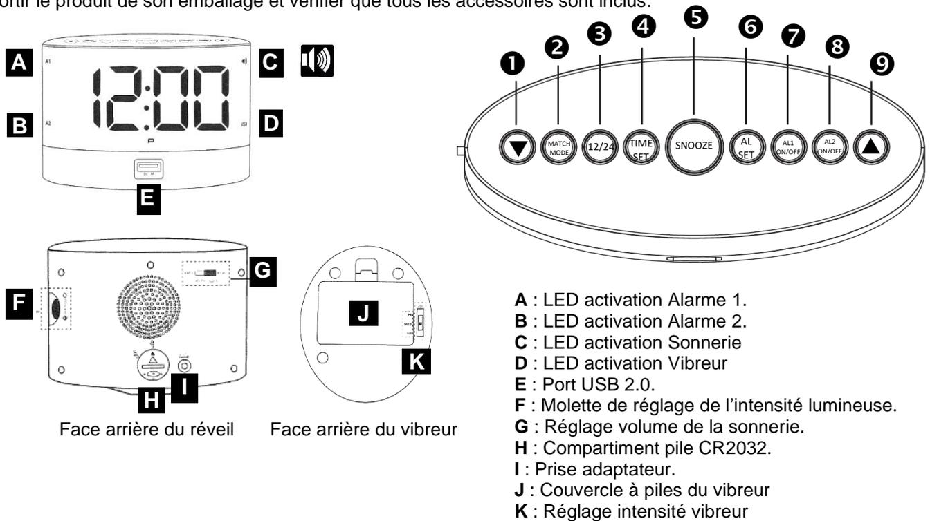
1. Brancher l'embout de l'adaptateur dans l'emplacement prévu à l'arrière du réveil (I). Puis brancher l'adaptateur sur une prise secteur (230V/ 50 Hz) : l'écran s'allume. Si l'affichage 12 : 00 n'apparaît pas, régler la luminosité de l'écran (F).
