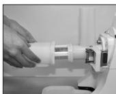
**5.** Retirez le boîtier de la sortie en le faisant coulisser de la structure principale. Notez que le tamis et/ou les doubles engrenages peuvent aussi être enlevés avec le boîtier de la sortie.
