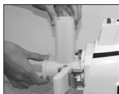
**1.** Faites coulisser le **boîtier du double engrenage** dans la Structure principale et repoussez-le jusqu'à ce qu'il entre en place dans la structure principale.
