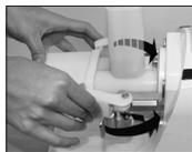
**5.** Fermez les **loquets** sur les pattes du boîtier de sortie et refermez les loquets en les repoussant sur les pattes en métal.
