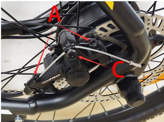
2. Lors du réglage du frein, veuillez faire attention à la plaquette de frein et au disque de frein (point D) pour l'uniformité du dégagement. Gardez la distance parallèle verticale et latérale, desserrez la vis pour ajuster (point A sur l'image). Le frein doit être réglé de manière à pouvoir être activé par la force de 6-8 N/m.
