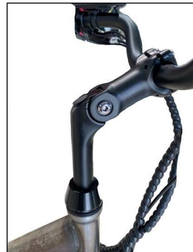
Pour régler l'inclinaison du guidon, desserrez la vis-pivot de potence illustrée dans l'image avec une clé hexagonale de 5mm sélectionnez la position et serrez-le.
