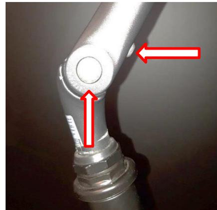
Vous devrez peut-être alors régler la position du guidon sur la potence en desserrant les vis du cache potence, tourner le guidon à votre convenance et serrer ces mêmes vis.
