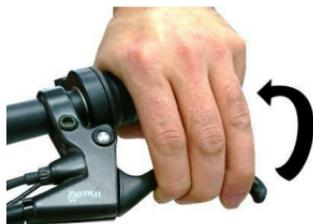
Pendant que la roue tourne, actionnez la poignée de frein, l'arrêt de la rotation de la roue **doit être instantané**.
