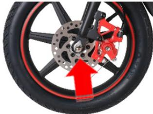
Le remontage se fait en repositionnant la roue et en resserrant les boulons. Attention à l'alignement des roues et au réglage du disque de frein comme décrit dans ce manuel. Faites attention à ne pas serrer le frein quand le disque n'est plus dans l'étrier, ceci afin de ne pas bloquer le système de frein.
