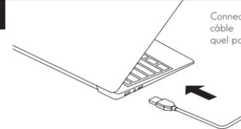
Connectez l'autre extrémité du câble USB (type A) à n'importe quel port USB actif de l'ordinateur.
