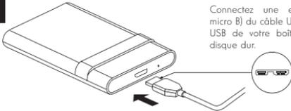
Connectez une extrémité (type micro B) du câble USB dans le port USB de votre boîtier externe de disque dur.
