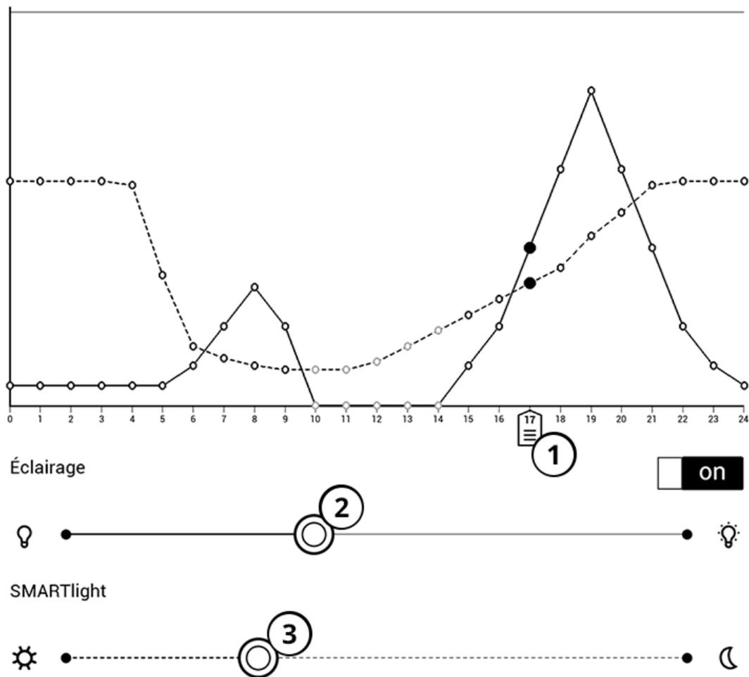
Lorsqu'une nouvelle configuration de paramètres est créée, un graphique sera affiché sur l'écran où vous pourrez régler la luminosité de l'éclairage de façade et sa température de couleur SMARTlight. Pour définir un paramètre, positionnez le curseur (Réf. 1) sur le moment requis sur le graphique, et en déplaçant les diapositives sous le graphique (Réf. 2, 3) définissez la luminosité et température adéquats pour chaque heure.
