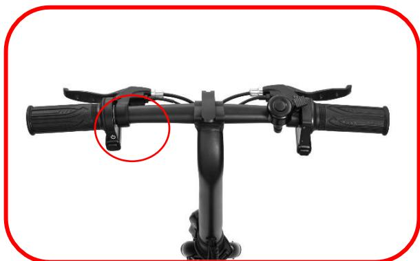
Como se muestra en la foto, el botón con un círculo rojo se utiliza para encender y apagar el dispositivo. Presione hacia arriba para encenderlo. Luego hacia abajo para apagar.
