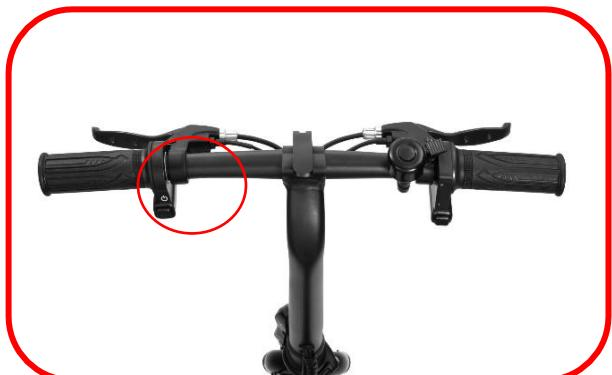
Como se mostra na fotografia, o botão de círculo vermelho é utilizado para ligar e desligar o seu dispositivo. Empurrar para cima para ligar. Em seguida, desligar-se.
