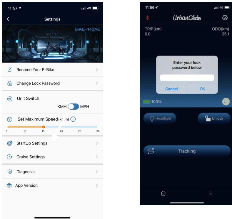
Al hacer clic en el candado, la aplicación te pide una contraseña para bloquear o desbloquear tu bicicleta eléctrica. Cuando se apaga la moto, se bloquea automáticamente, sólo se puede circular con ella cuando está encendida.
