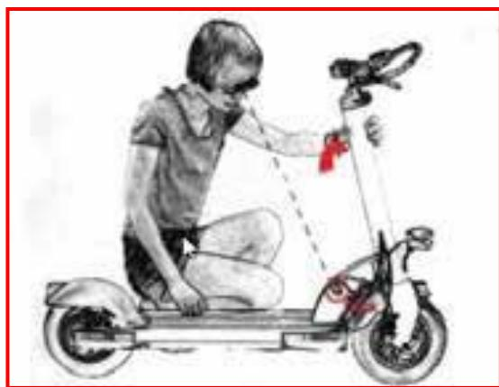
Poi tira la maniglia pieghevole e abbassa lo stelo sul vassoio del tuo scooter. Una volta abbassato al massimo, riportare la fibbia di sicurezza nella sua posizione originale.
