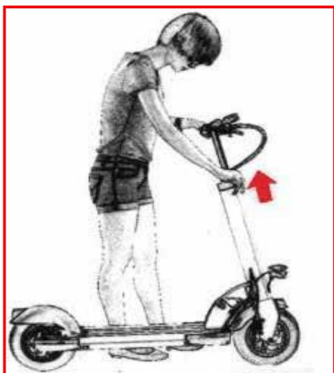
Regola la dimensione del tuo manubrio allentando la fibbia del morsetto sull'attacco. Fate attenzione a non superare il limite di altezza indicato. Controlla che il tuo manubrio sia stabile e che il morsetto sia stretto.
