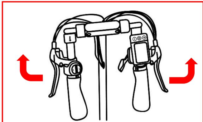
Klappen Sie die Griffe einfach aus, indem Sie sie gerade halten. Prüfen Sie, ob sie stabil sind, bevor Sie Ihr Produkt verwenden.
