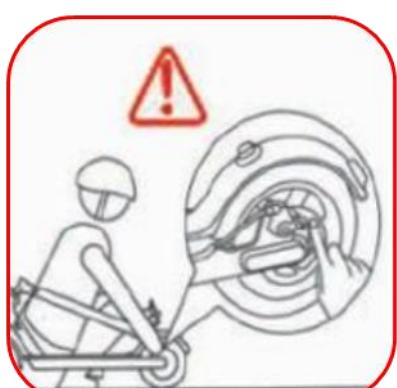
No toque los frenos de disco después de usar su scooter, estas partes pueden estar calientes después de un largo viaje.
