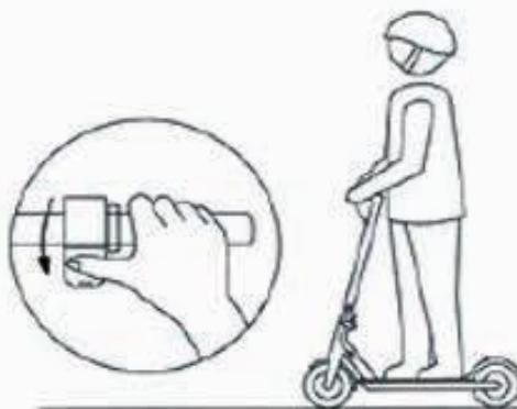
Premere delicatamente il grilletto dell'acceleratore per iniziare a guadagnare velocità.
