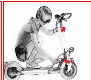
Breng vervolgens de veiligheidsgesp terug in zijn oorspronkelijke positie en controleer of uw stuur stabiel staat.
