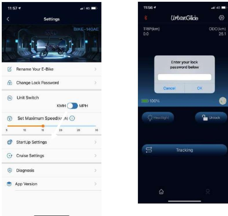
Ao clicar no cadeado, a aplicação pede-lhe uma palavra-chave para bloquear ou desbloquear a sua bicicleta eléctrica. Quando se desliga a bicicleta, esta trava automaticamente, só se pode andar com ela quando está ligada.
