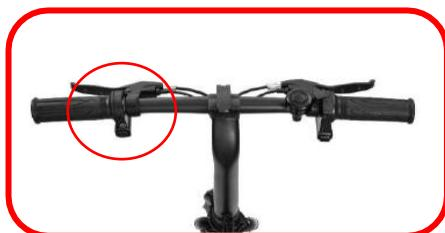
Comme indiqué sur la photo, le bouton entouré en rouge permet d'allumer et d'éteindre votre appareil. Poussez vers le haut pour allumer. Puis vers le bas éteindre. Pour allumer la lumière avant, appuyez 3 secondes sur le bouton situé sous l'indicateur de batterie.
