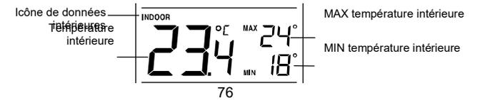
**Note :** La plage de relevé des températures MIN/MAX intérieures s'étend de -9°C à +38°C avec une résolution de 1°C.
