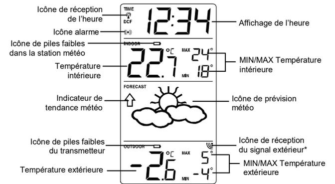
\* Quand le signal de l'émetteur extérieur est capté par la Station météo, cette icône s'allume. (Dans le cas d'une non réception, l'icône ne s'affiche pas sur le LCD. Ceci permet à l'utilisateur de savoir si la dernière réception a réussi (icône présente) ou non (icône absente).
