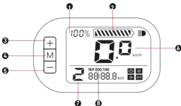
(1). Niveau de batterie % (2). Niveau de batterie (3). Bouton + (4). Bouton M (5). Bouton - (6). Vitesse (7). Niveau de d'assistance (1 : 15 km/h ; 2 : 20 km/h ; 3 : 25 km/h) (8). Mode d'affichage.
