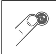
4. Aby wyjść z ustawień systemu oszczędzania energii należy wcisnąć i przytrzymać przycisk Lungo przez 3 sekundy.
