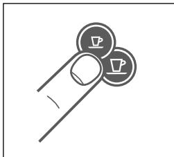
5. Druk op de knop Espresso (40 ml) of Lungo (110 ml) om de machine in te schakelen. Na extractie stopt de machine automatisch. Druk nogmaals om de doorstroming van de koffie te stoppen of er koffie aan toe te voegen.
