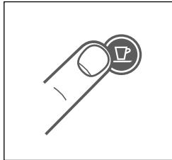
1. Con la máquina apagada, mantenga pulsado el botón Lungo durante 5 segundos.
