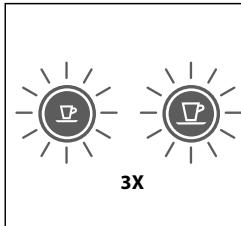
2. Oba przyciski zamigają szybko, trzykrotnie - urządzenie wróciło do ustawień fabrycznych.
