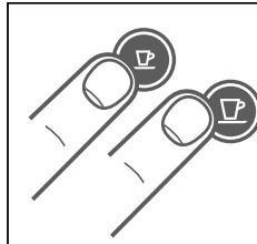
Aby wyłączyć urządzenie, zanim wejdzie w stan czuwania, należy przycisnąć jednocześnie przycisk Espresso i Lungo.
