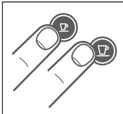
1. U schakelt de leegmodus in door de knoppen Espresso en Lungo tegelijk in te drukken, zodat de machine wordt uitgeschakeld.
