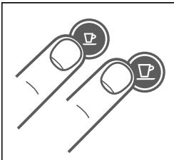
1. Para ir al modo de vaciado, pulse los botones Espresso y Lungo a la vez para apagar la máquina.
