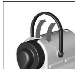
6. Usunąć filiżankę. Podnieść i zamknąć dźwignię w celu odrzucenia kapsułki do pojemnika na zużyte kapsułki.
