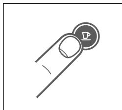
3. Ennek megváltoztatásához nyomja meg az Espresso gombot: Egyszer a 9 perc utáni kikapcsolt állapothoz.
