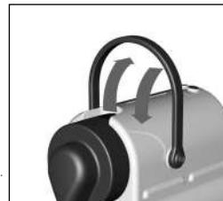
6. Verwijder het kopje. Plaats de capsuleklem omhoog en weer omlaag om de capsule uit te werpen in het opvangbakje voor capsules.
