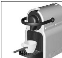
4. Cierre la palanca y coloque una taza debajo de la salida del café.
