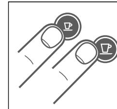
3. Pulse los botones Espresso y Lungo simultáneamente durante 3 segundos.
