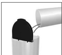
7. Rellene el depósito de agua con la solución descalcificadora, recogida en el recipiente, y repita los pasos 4 y 6.
