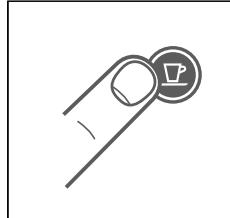
4. Druk drie seconden lang op de knop Lungo om de energiebesparingsmodus af te sluiten.
