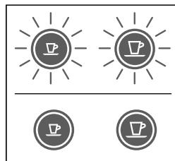
3. De indicatielampjes knipperen vervolgens normaal, net als bij het opwarmen, totdat de machine klaar is voor gebruik.
