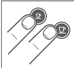
1. Az ürítési módba való belépéshoz nyomja meg az Espresso és Lungo gombot, hogy kikapcsoljon a gép.
