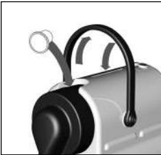
2. Llene el depósito de agua con agua potable e introduzca la cápsula.
