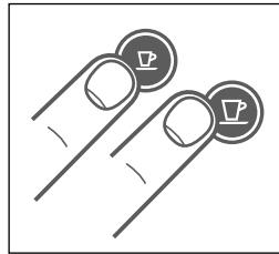
10. Para salir del modo Descalcificación, pulse los botones Espresso y Lungo simultáneamente durante 3 segundos.
