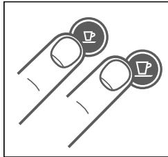
1. Aby wejść w tryb opróżniania, należy wcisnąć przyciski Espresso i Lungo jednocześnie, w celu wyłączenia maszyny.
