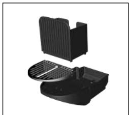
2. Vacíe la bandeja antigoteo y el contenedor de cápsulas usadas.
