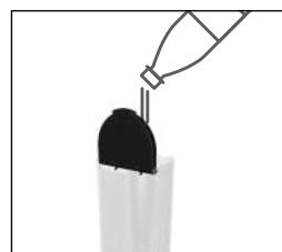
8. Vacíe y enjuague el depósito de agua. Línelo con agua potable.
