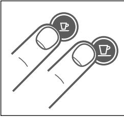
5. Aby włączyć tryb odkamieniania należy w stanie gotowości wcisnąć jednocześnie przyciski Espresso i Lungo na 3 sekundy.
