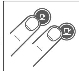
10. Druk drie seconden lang de knoppen Espresso en Lungo tegelijk in om de ontkalkingsmodus af te sluiten.
