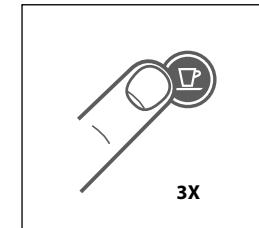
5. Nyomja meg a Lungo gombot a gép átmosásához. Ismételje meg 3-szor.
