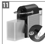
Wenn die Maschine bereit ist, drücken Sie die Lungotaste, um die Maschine zu spülen.
