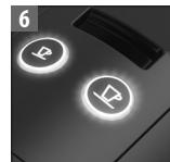
Blikající tlačítko: nahřívání. Svítící tlačítko: připraven k používání.
