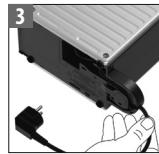
Führen Sie das restliche Kabel durch die Kabelführung unter der Maschine und stellen Sie die Maschine in die aufrechte Position.
