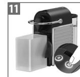
11 Wciśnąć przycisk Lungo, aby wypłukać urządzenie.
