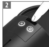
Włączyć urządzenie. Pulsujące diody: nagrzewanie przez około 25 sekund. Światło stałe: gotowe.
