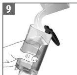
Znovu naplňte zásobník na vodu odvápněvacím roztokem z nádoby a zopakujte krok 8.
