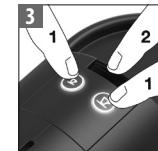
Για να αυξήσετε τον αυτόματο χρόνο σβήσιματος από 9 σε 30 λεπτά: Σβήστε τη μηχανή και πατήστε, ταυτόχρονα, τα κουμπιά Espresso και Lungo, και έπειτα πατήστε το κουμπί ON/OFF.
