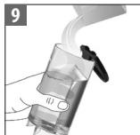
Füllen Sie die im Behälter aufgefangene gebrauchte Entkalkungslösung wieder in den Wassertank und wiederholen Sie Schritt 8.
