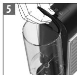
Para sacar el depósito de agua, tire de la tapadera. O depósito de água pode ser manuseado pela respectiva tampa.
