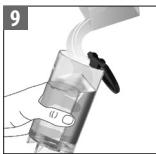
Γεμίστε το δοχείο νερού με το χρησιμοποιημένο διάλυμα νερού και καθαριστικού που έχει συγκεντρωθεί στο δοχείο που βάλατε κάτω από το στόμιο εκρής κι επαναλάβετε το βήμα 8.
