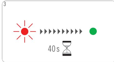
La machine s'allume automatiquement après le retrait du porte-capsule. Le témoin lumineux se met à clignoter en rouge tandis que la machine chauffe pendant 40 secondes environ. Ensuite, le témoin lumineux passe au vert continu. La machine est opérationnelle.
