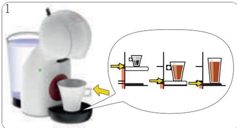
1 Ajustez la position du bac d'égouttage. Placez une tasse de taille appropriée sur le bac. Voir 3. « EXEMPLES DE BOISSONS » ou l'emballage. Vérifiez si le réservoir d'Eau contient assez d'eau fraîche.
