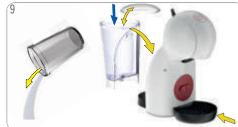
Videz le récipient. Versez de l'Eau potable fraîche dans le réservoir. Insérez le réservoir dans la machine. Remettez le bac d'égouttage en place. La machine est opérationnelle.
