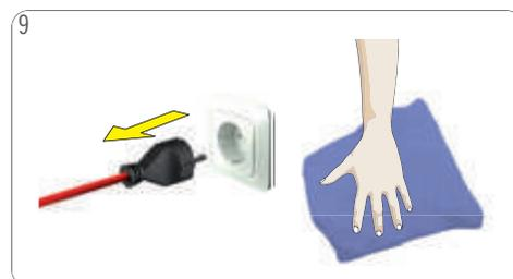
Débranchez la fiche de courant ! Nettoyez la machine avec un chiffon doux humide. Essuyez-la avec un chiffon doux sec.
