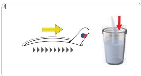
4 Poussez le levier de sélection en position « HOT ». Le détartrage démarre.
