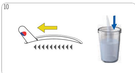
Poussez le levier de sélection en position « COLD ». Le rinçage démarre.
