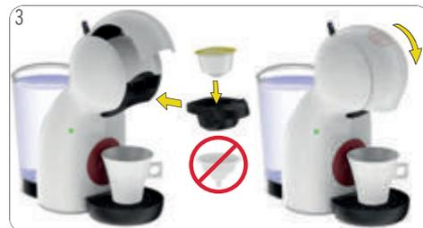
3 Assurez-vous que l'outil de rinçage n'est pas à l'intérieur. Insérez une première capsule dans le porte-capsule. Réintroduisez celui-ci dans la machine. Fermez la poignée de blocage.
