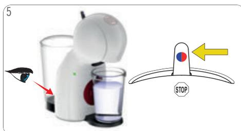
5 Contrôlez visuellement que le réservoir est vide. Poussez le bouton de sélection en position « STOP ». Le témoin émet une lumière verte continue à la fin du détartrage.
