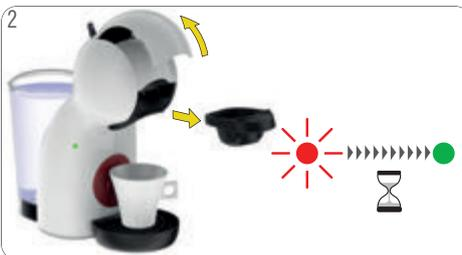
2 Ouvrez la poignée de verrouillage. Sortez le porte-capsule. La machine se met en marche automatiquement. Le témoin lumineux se met à clignoter en rouge tandis que la machine chauffe pendant 40 secondes environ. Ensuite, le témoin lumineux passe au vert en continu. La machine est prête à l'utilisation.
