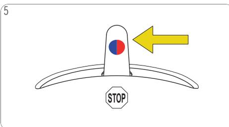
5 Restez à côté de la machine durant la préparation ! Une fois le niveau désiré atteint, poussez le levier de sélection en position « STOP ». La machine arrête la préparation.
