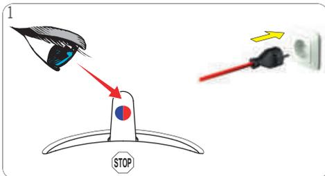
Assurez-vous que le levier de sélection est en position « STOP ». Veillez à utiliser la tension prescrite au chapitre 2. « PRÉSENTATION DE LA MACHINE » à la page 5. Raccordez le câble d'alimentation à la prise de courant secteur.
