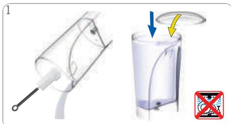
Rincez et nettoyez le réservoir d'Eau. Utilisez une brosse propre utilisable pour les produits alimentaires et un détergent au besoin. Remplissez-le de nouveau d'eau potable fraîche et introduisez-le dans la machine. Le réservoir d'eau n'est pas conçu pour le lave-vaisselle.
