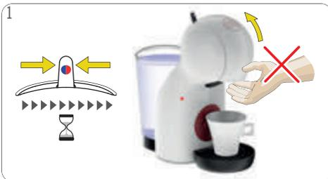
Poussez le bouton de sélection en position « STOP ». Ouvrez la poignée de verrouillage. Si la poignée de verrouillage ne peut pas s'ouvrir, attendez 20 minutes et réessayez.
