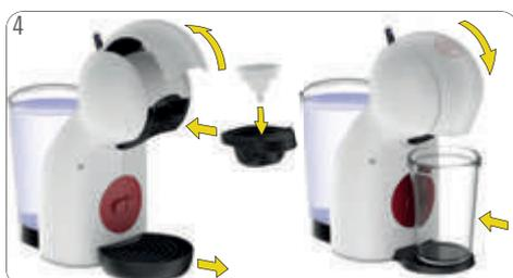
Ouvrez la poignée de verrouillage. Placez l'accessoire de rinçage dans le porte-capsule. Insérez le porte-capsule dans la machine. Fermez la poignée de blocage. Enlevez le bac d'égouttage. Placez un grand récipient vide sous la sortie café.
