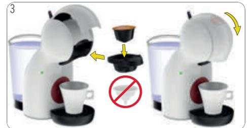
3 Assurez-vous que l'outil de rinçage n'est pas à l'intérieur. Insérez une capsule dans le porte-capsule. Réintroduisez celui-ci dans la machine. Fermez la poignée de blocage.
