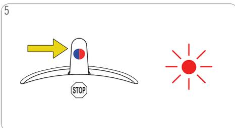
Au bout de 60 secondes environ, poussez le levier de sélection en position « STOP ». Le témoin lumineux clignote en rouge pendant 5 secondes environ.
