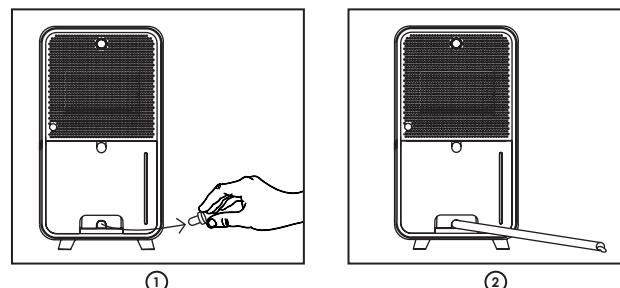
CONNEXION POUR POMPE DE RELEVAGE/LIFT PUMP CONNECTION/ANSCHLUSS FÜR KONDENSATPUMPE/CONEXIÓN DE LA BOMBA DE ELEVACIÓN/LIGAÇÃO DA BOMBA DE ELEVAÇÃO/AANSLUITING OPVOERPOMP/PODŁĄCZENIE POMPY SSĄCEJ/PUMPUN LIITÄNTÄ
