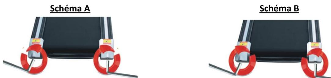
Schéma A : Méthode de correction de la déviation de la courroie sur la droite.
