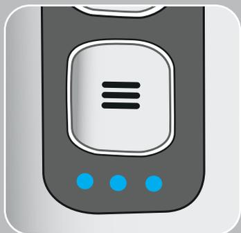
3. Les témoins lumineux clignotent pendant la charge. Lorsque les 3 témoins lumineux cessent de clignoter et restent allumés, l'appareil est complètement chargé. Retirez alors le câble de chargement de l'appareil.
