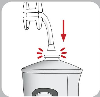
1. Insérez la tête de jet en H sur le haut de l'appareil et appuyez pour la mettre en place.
