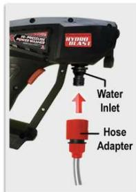
Pour fixer le tuyau, il suffit de pousser le raccord de tuyau ou le raccord automatique de tuyau d'arrosage sur l'entrée d'eau du pistolet Hydroblast™.
