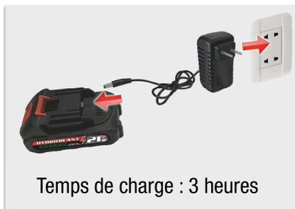
Connectez le bloc-batterie au chargeur et branchez-le. Une charge complète prend 3 heures. Le voyant rouge s'allume pendant la charge et le voyant vert lorsqu'elle est terminée. Débranchez l'appareil après la charge.
