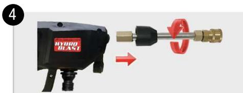
4 Pour retirer la buse à longue portée, faites glisser le capuchon protecteur en caoutchouc pour faire apparaître l'écrou hexagonal. Utilisez une clé hexagonale (ou votre main) pour tourner l'embout longue portée dans le sens inverse des aiguilles d'une montre jusqu'à ce qu'il se desserre et se détache.
