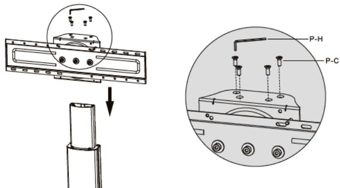
Insérez le plateau de fixation TV (D) contre la colonne inférieure et fixez-la avec les vis fournies.
