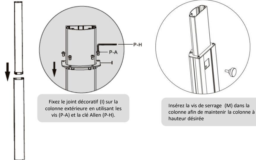
Insérez la colonne intérieure (J) dans la colonne extérieure (K).
