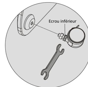
Insérez les roulettes aux emplacements prévus et ajustez la hauteur au niveau des écrous inférieurs.
