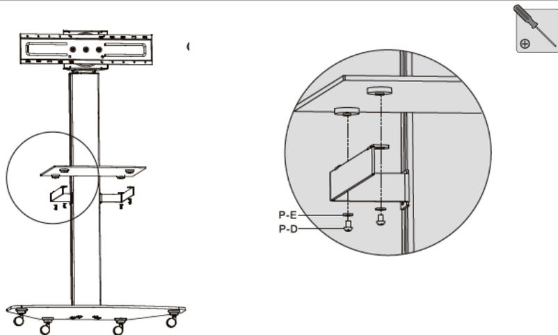
Posez l'étagère sur les deux bras et fixez-la à l'aide des vis (P-E) et des rondelles (P-D). Utilisez un tournevis adapté.
