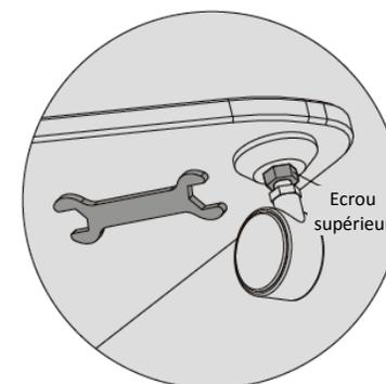
Assurez-vous que les roulettes soient à la même hauteur puis fixez-les au niveau des écrous supérieurs.
