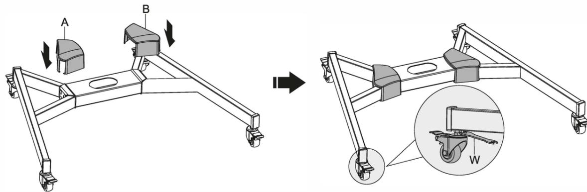
**NOTE :** Verrouillez les freins des roulettes pour éviter tout mouvement brusque lors de l'installation.
