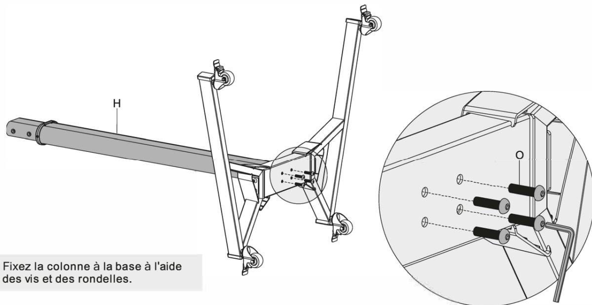
Fixez la colonne à la base à l'aide des vis et des rondelles.
