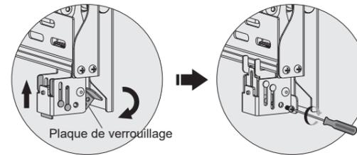
Tournez les plaques de verrouillage vers le bas pour fixer la plaque murale et serrez les vis pour la fixer.
