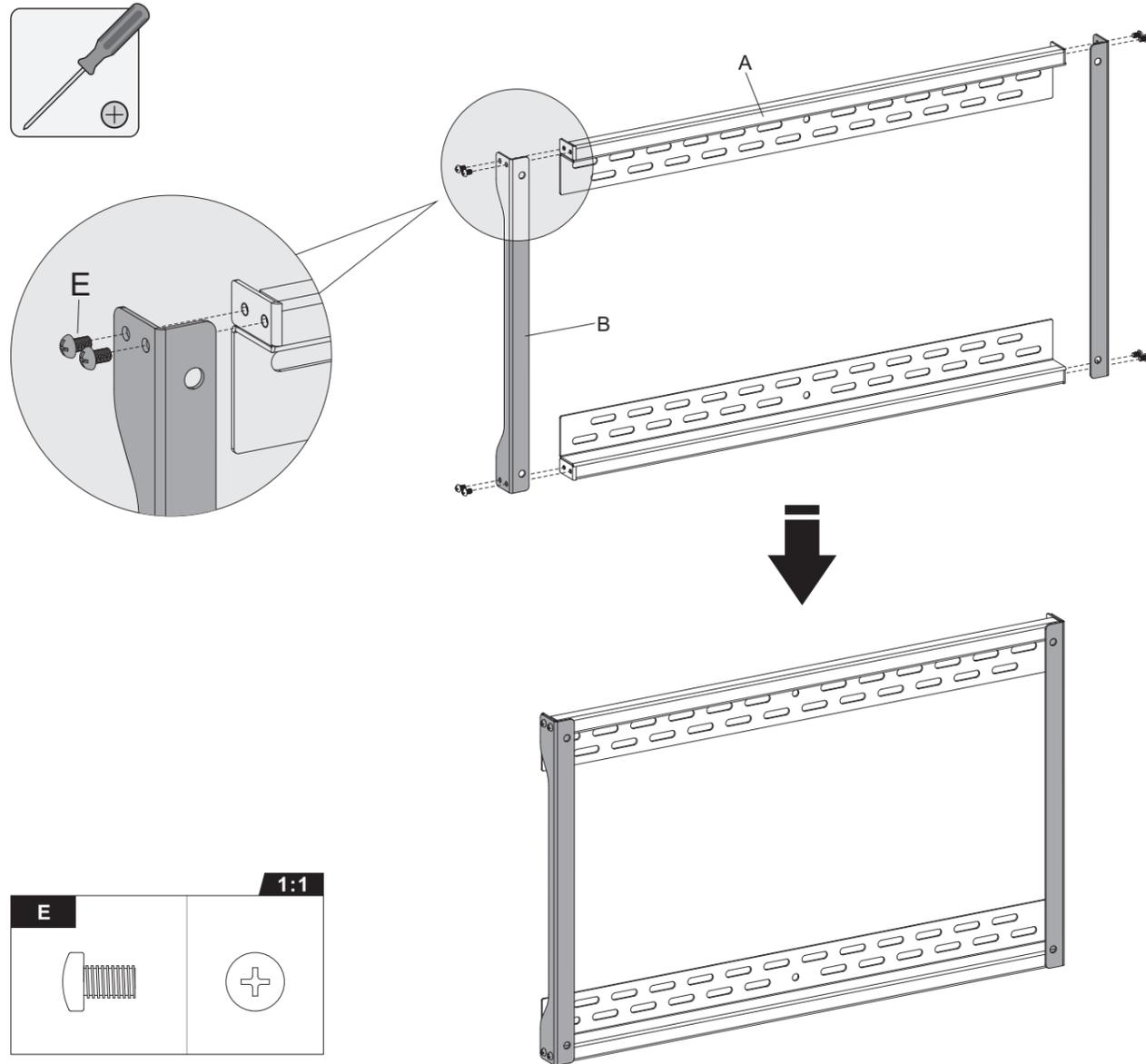
Fixez les plaques de connexion aux plaques murales à l'aide des vis appropriées.
