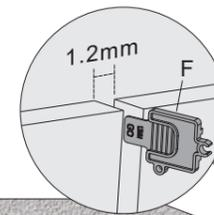
**Note:** Utilisez la pièce de verrouillage en plastique pour mesurer et garder un espace de 1,2 mm entre les écrans.
