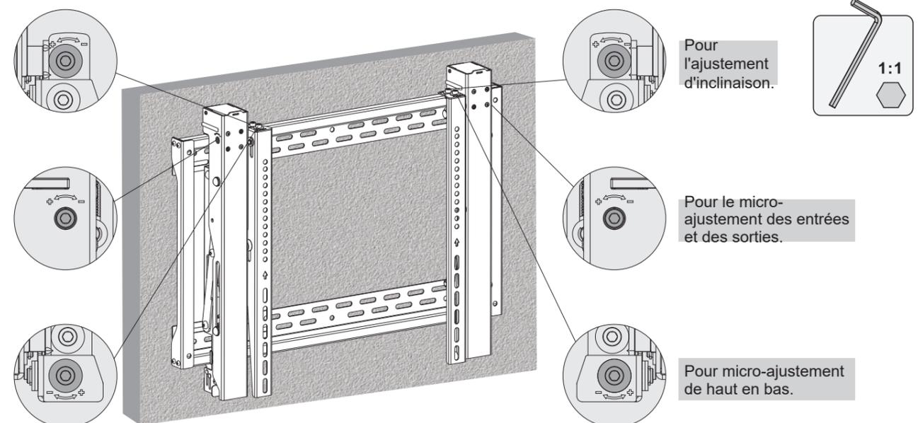
Pour l'ajustement d'inclinaison.
