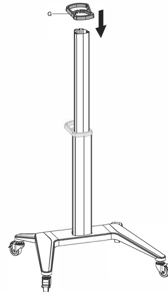
**3. Attach the Connector to the Column / Fixer le connecteur à la colonne**
