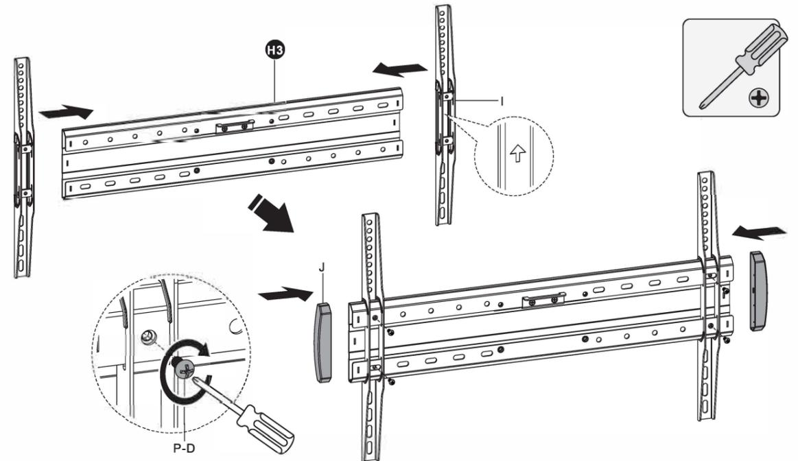
**5a. Attach TV Bracket to Flat Back Screen / Fixer le support sur un écran au dos plat**
