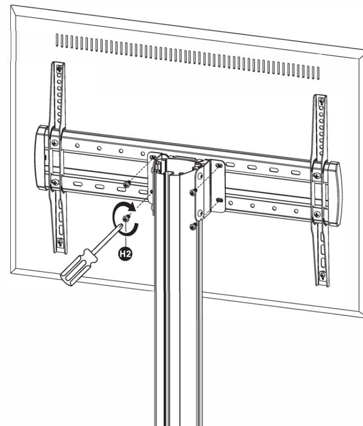
**7. Assemble the Top Cover / Installation du couvercle**
