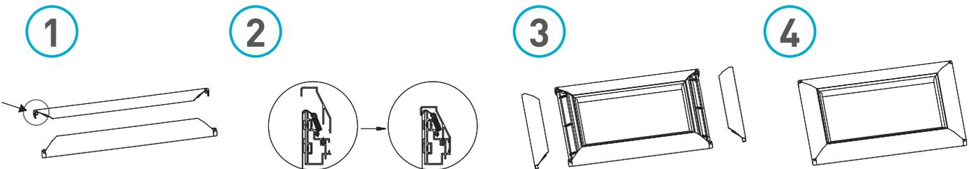
Insérer les embouts en plastiques aux coins des caches cadre métalliques.
