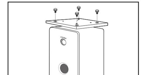
Après avoir fixé le socle de l'enceinte, vissez les pointes de découplage sur celui-ci (pas d'outillage nécessaire). Remarque : La fixation de patins ou de pointes de découplage permet de limiter les vibrations transmises au sol.
