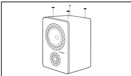
Nous préconisons de coller les patins en caoutchouc pour les enceintes prévues avec le socle amovible. Si vous utilisez les enceintes sans le socle amovible, il est nécessaire de mettre les patins en caoutchouc au niveau des inserts prévus à cet effet, afin d'éviter tout dommage. En règle générale, il vous est possible de coller les patins en caoutchouc en-dessous de l'enceinte ou de son socle afin de protéger l'enceinte elle-même et son support.
