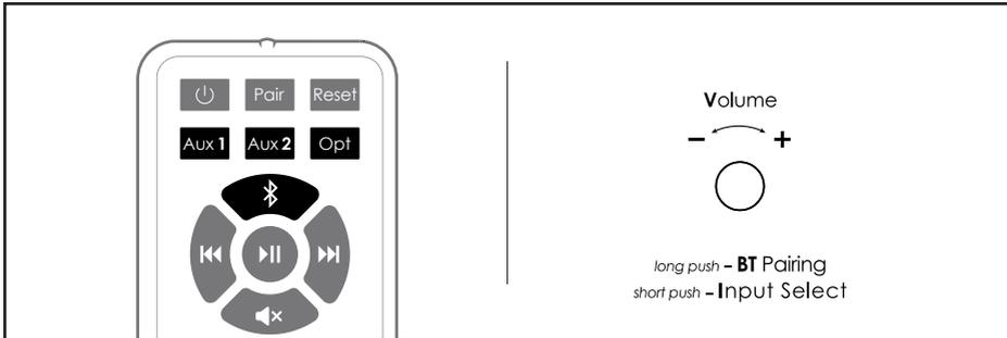
Il est possible de sélectionner l'entrée ou la source grâce à la télécommande fournis ou bien avec le «Réglage volume» au dos de l'enceinte.
