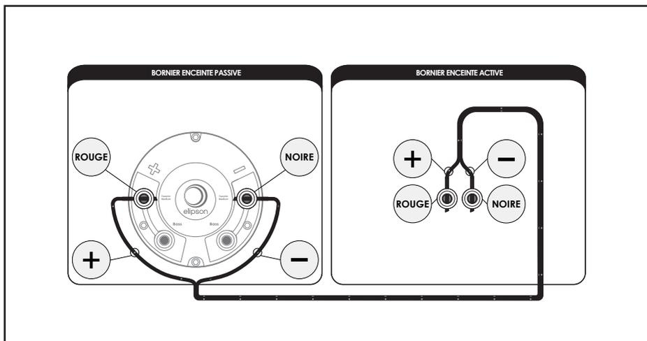
Remarque : Ne jamais brancher deux enceintes actives ensemble en stéréo. Toujours utiliser une enceinte active et une enceinte passive pour une configuration stéréo.
