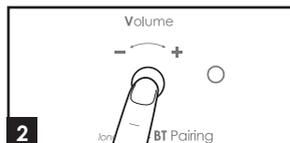
Effectuez un appui court sur le réglage du volume pour passer en sélection d'entrée bluetooth, ou pour sélectionner une autre entrée
