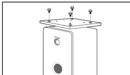
Après avoir fixé le socle de l'enceinte, vissez les pointes de découplage sur celui-ci (pas d'outillage nécessaire). Remarque : La fixation de patins ou de pointes de découplage permet de limiter les vibrations transmises au sol.
