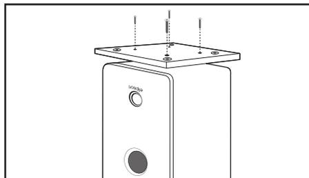
Retournez avec précaution l'enceinte et posez-la sur le sol préalablement recouvert des mousses d'emballage, ou d'un tapis, afin de ne pas abîmer sa partie supérieure. Prenez soin de ne pas endommager l'ébénisterie, la façade laquée ou les haut-parleurs pendant l'opération. Posez le socle sur l'enceinte et fixez-le à l'aide des vis fournies.
