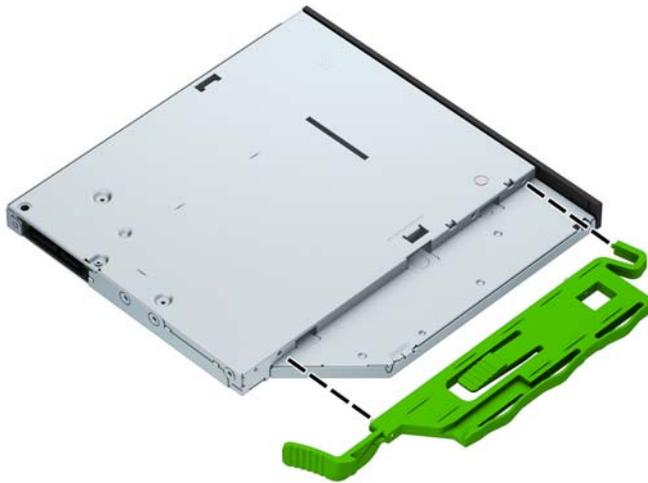
9. Faites glisser l'unité optique à travers le châssis avant jusqu'au fond du compartiment jusqu'à ce qu'elle s'emboîte (1), puis branchez le câble d'alimentation (2) et le câble de données (3) à l'arrière de l'unité.
