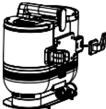
3. Retire el soporte de la empuñadura y encájelo en el lado izquierdo de la tapa trasera.
