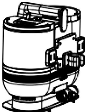
4. Verwijder de slangconnector, lijn het gat in de slangbocht uit met de achterkant van de basis, steek hem er stevig in en hoor een "plop".
