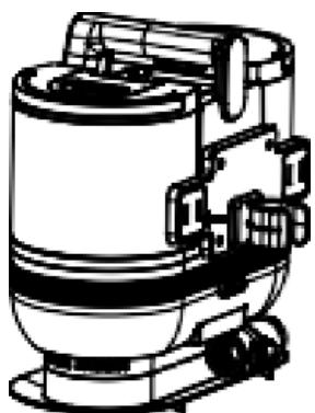
4. Entfernen Sie den Schlauchanschluss, richten Sie das Loch im Schlauchbogen an der Rückseite der Basis aus, führen Sie ihn fest ein und hören Sie ein "Plopp".
