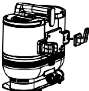
3. Retirer le support de la poignée et l'enclencher sur le côté gauche du couvercle arrière.
