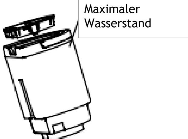
3. Setzen Sie den Frischwassertank in den Körper ein.
