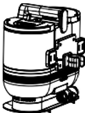
4. Retire el conector de la manguera, alinee el orificio del codo de la manguera con la parte posterior de la base, insértelo firmemente y escuche un "pop".
