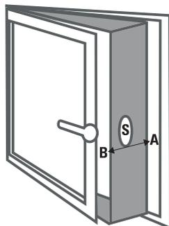
**7 Mettre la gaine dans l'orifice, tirer les deux cordons et remonter le serre cordon au maximum pour que cela soit hermétique.**
