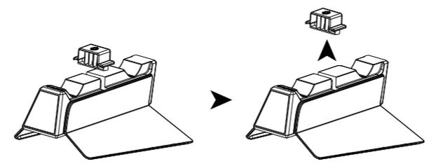
Schritt 2: Montieren Sie das Unterteil und das Oberteil des Helmhalters zusammen
