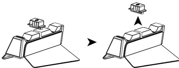
Passaggio 2: assemblare insieme la parte inferiore e la parte superiore del portacasco
