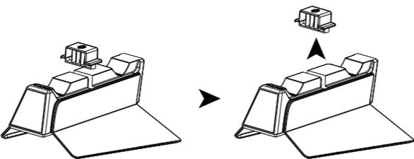
Passo 2: Monte a parte inferior e a parte superior do suporte do capacete juntas
