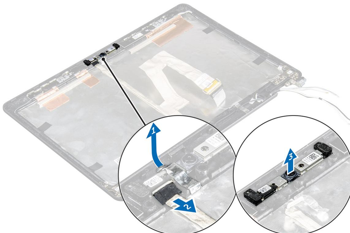
Figure 6. Retrait de la caméra d'un système tactile
