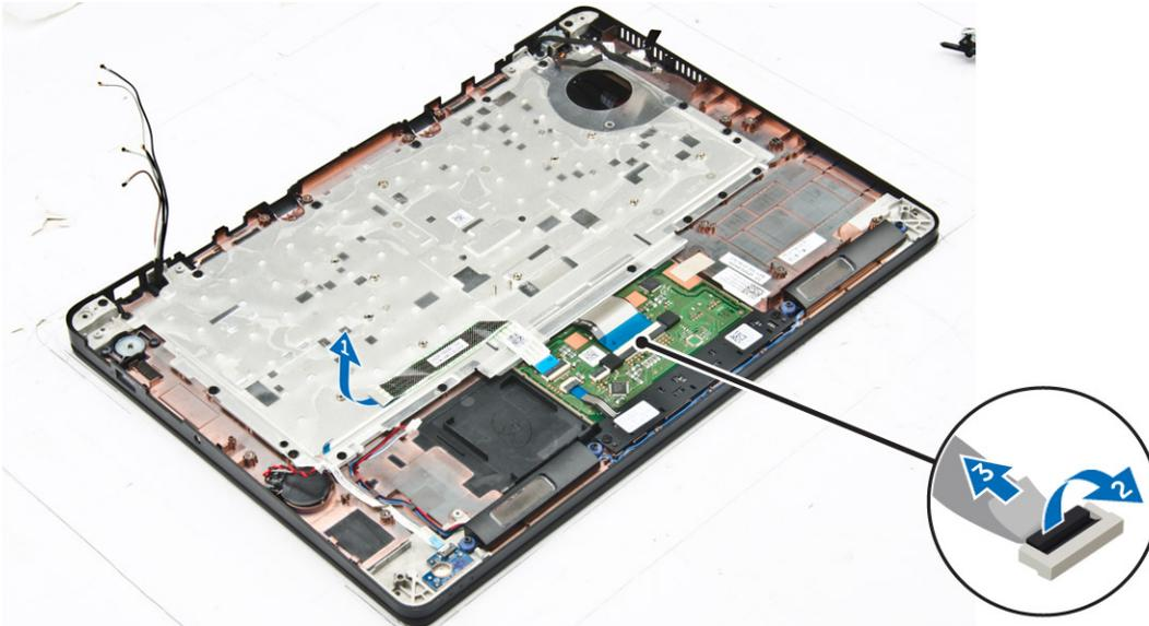
5. Retirez les vis qui fixent l'assemblage du clavier à l'ordinateur [1].
