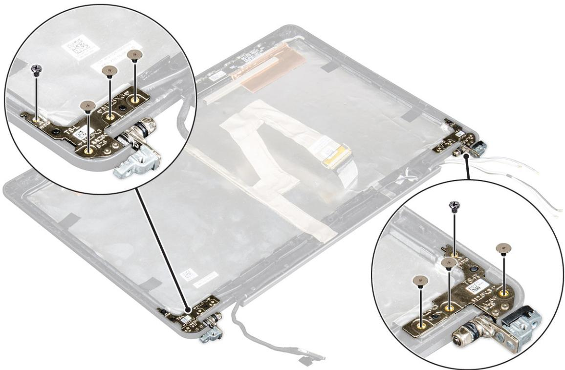
Figure 2. Retrait des charnières pour un système tactile
