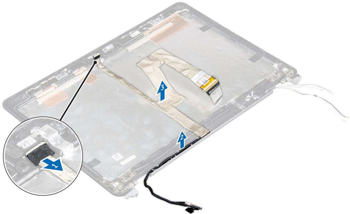
Figure 4. Retrait du câble eDP pour les systèmes tactiles
