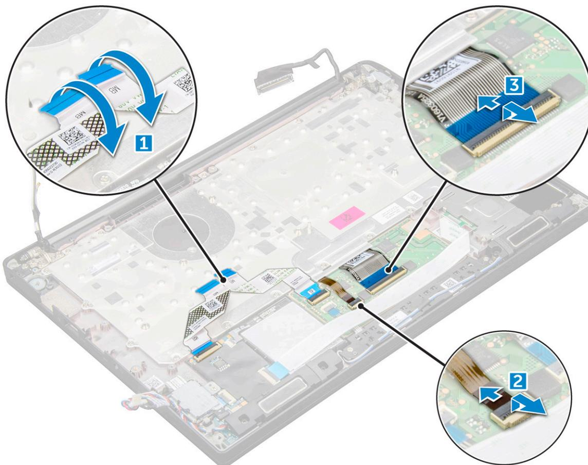
11. Pour retirer l'assemblage de clavier :
