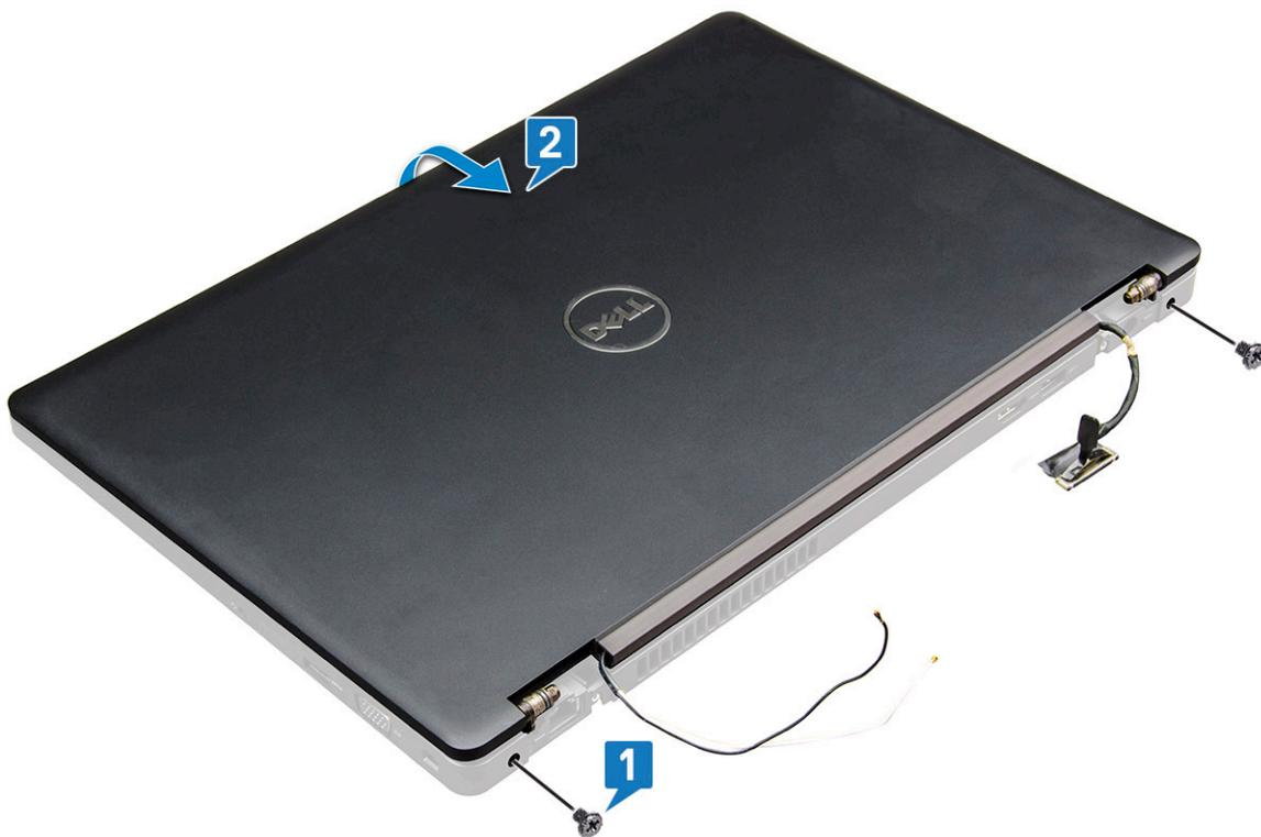
7. Faites glisser vers le haut l'assemblage de l'écran pour le retirer de la base du système.
