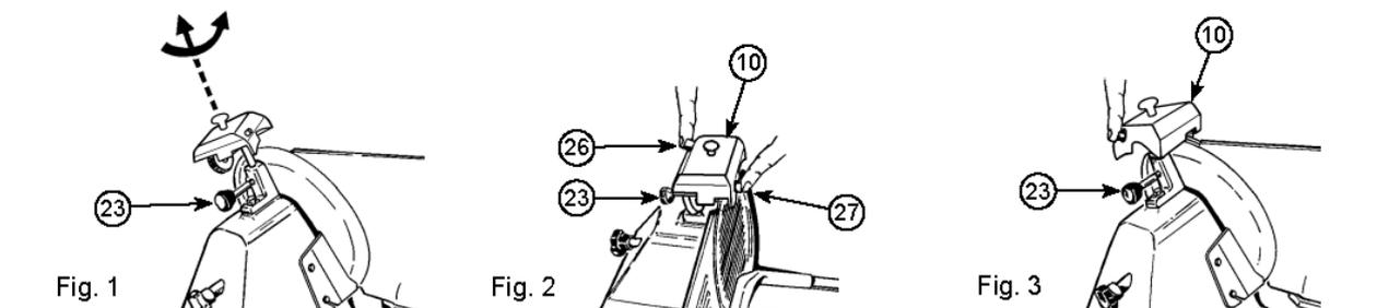
Let Op: Het mes is gehard, daarom moet het alleen worden geslepen als het snijden afneemt. De mes bescherming moet zijn gesloten met een integraal messen slijper tijdens het slijpproces.
