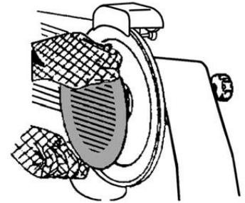
Wenn der Schiebeschlitten nicht mehr leichtgängig Rutscht, legen Sie die Maschine an die Seite. Reinigen Sie die Geitschiene (29) und schmieren Sie diese mit Vaseline oder industriellem Öl.
