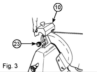
N.B. Es muss beachtet werden, dass die Klinge höchst widerständig ist, und deswegen muss sie nur dann geschliffen werden, wenn die Schneidekapazität sinkt. Das Messerblech oder Schutzblech muss bei den Schneidern mit einem eingebauten Messerschärfer während des Schleifenvorgangs geschlossen sein.
