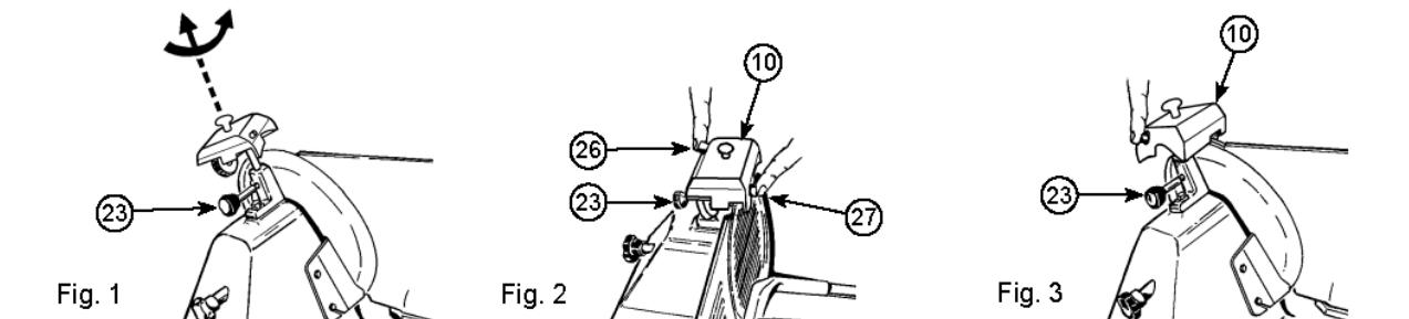
NB: il faut noter que la lame est très résistante, par conséquent elle doit être affûtée uniquement lorsque la capacité de coupe diminue. La plaque de jauge ou la plaque de protection de la trancheuse doit être fermée par mise en place de l'aiguiseur intégré pendant l'affûtage.
