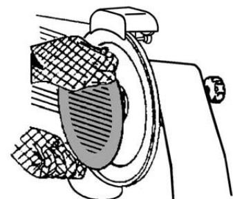
Wenn der Schiebeschlitten nicht mehr leichtgängig Rutscht, legen Sie die Maschine an die Seite. Reinigen Sie die Geitschiene (29) und schmieren Sie diese mit Vaseline oder industriellem Öl.
