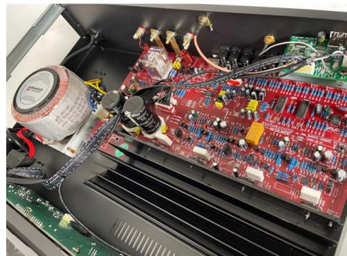
Le travail d'Advance pour se démarquer porte entre autres sur la qualité primordiale de l'alimentation linéaire, à commencer par le transformateur torique de suivi d'un filtrage par deux condensateurs de 6800 µF/71 V, puis de multiples régulations également très bien filtrées destinées à chaque circuit du STREAM 80.
