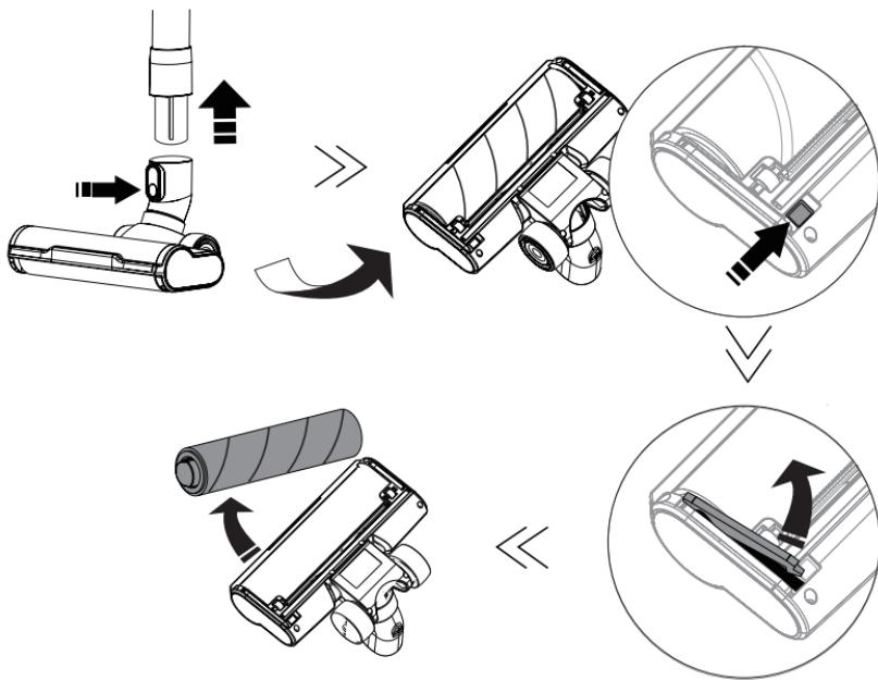
Una vez extraído el cepillo de su bloque, utilice un objeto afilado para retirar las cerdas y el pelo enrollado. El cepillo se puede enjuagar bajo agua limpia para limpiarlo. Sólo asegúrate de dejarlo secar durante 24 horas durante 24 horas y asegúrese de que está completamente seco antes de volver a instalarlo como se indica a continuación:
