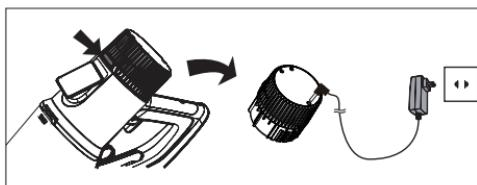
A / Rimuovere la batteria dal dispositivo e inserire l'adattatore AC direttamente nella batteria.
