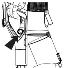
También es posible eliminar el colector tirando del anillo para vaciarlo completamente vaciarlo completamente y limpiarlo.
