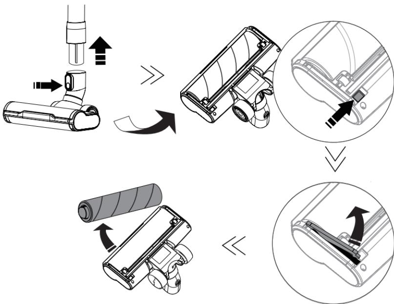
Una volta che la spazzola è stata rimossa dal suo blocco, utilizzare un oggetto appuntito per rimuovere le setole e i capelli arrotolati. La spazzola può essere sciacquata sotto acqua pulita per pulirla. Basta essere sicuri di lasciarlo asciugare per 24 ore per 24 ore e assicurarsi che sia completamente asciutto prima di reinstallarlo come segue:
