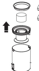
Reinigen Sie den Filter mit klarem Wasser, indem Sie ihn leicht abreiben.
