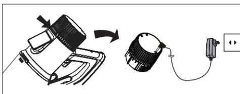
A / Retire la batería de su dispositivo y conecte el adaptador de CA directamente a la batería.
