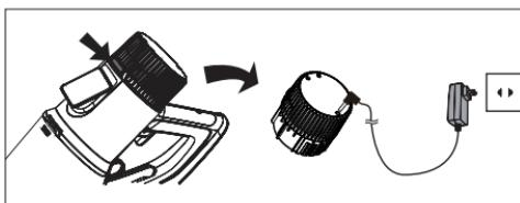
A/ Verwijder de batterij uit uw toestel en sluit de netsnoeradapter rechtstreeks aan op de batterij.
