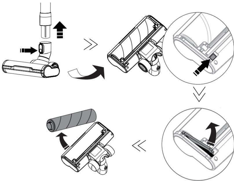
Une fois la brosse retirer de son bloc, utiliser un objet coupant pour éliminer poils et cheveux enroulés. Il est possible de passer la brosse sous l'eau claire pour la nettoyer. Veiller simplement à la laisser sécher pendant 24h et vous assurer qu'elle est complètement sèche avant de la réinstaller selon le schéma suivant :
