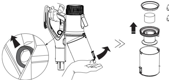
Nettoyer le filtre à l'eau claire ou avec un peu de détergent neutre en le frottant légèrement.
