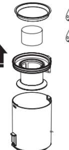
Pulire il filtro con acqua pulita o un po' di detergente neutro strofinandolo leggermente. Attendere almeno 24 ore che il filtro sia completamente asciutto prima di reinstallarlo nel collettore.
