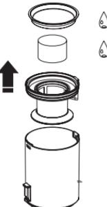
Limpie el filtro con agua limpia o con un poco de detergente neutro frotándolo ligeramente. Espere al menos 24 horas hasta que el filtro esté completamente seco antes de volver a instalarlo en el colector.
