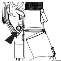
È anche possibile rimuovere il collettore tirando l'anello per svuotarlo completamente per svuotarlo completamente e pulirlo.
