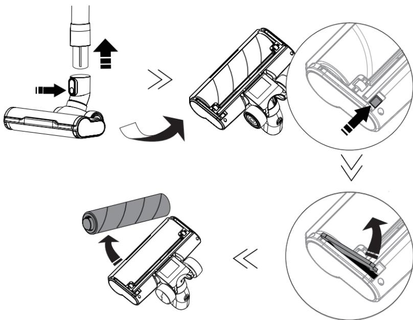
Zodra de borstel uit het blok is gehaald, verwijdert u met een scherp voorwerp de haren en het opgerolde haar. De borstel kan onder schoon water worden afgespoeld om hem schoon te maken. Zorg ervoor dat het 24 uur droog is. Gedurende 24 uur en zorg ervoor dat het volledig droog is alvorens het als volgt terug te plaatsen:
