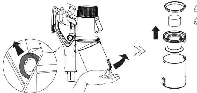
Maak het filter schoon met schoon water of een beetje neutraal schoonmaakmiddel door er lichtjes over te wrijven. Wacht ten minste 24 uur totdat het filter volledig droog is voordat u het weer in de collectorplaatst.
