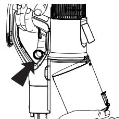
Drücken Sie die Taste am Staubbehälter um ihn zu öffnen und zu entleeren.
