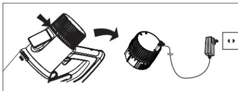
A / Retirer la batterie de votre appareil et brancher l'adaptateur secteur directement dans la batterie.
