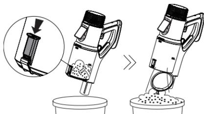
Pulse el botón del colector para abrirlo y vaciarlo.
