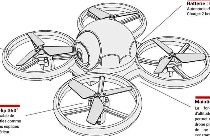
**Batterie : Li-Po 3.7V 800mAh**
