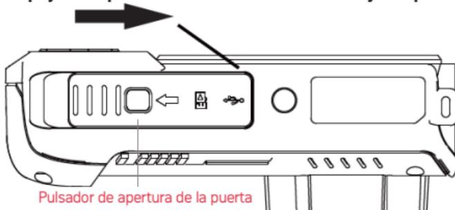
Sostenga el interruptor de la tapa y empuje la tapa en la dirección de la flecha para abrirla en
