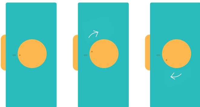
Point sur la molette de volume aligné avec le point sur la coque : l'appareil est éteint
