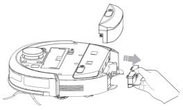
Remarque : Après avoir nettoyé le réservoir d'eau sale, essuyez la surface, puis installezle dans le robot jusqu'à ce qu'un message vocal indique "Réservoir d'eau sale installé".
