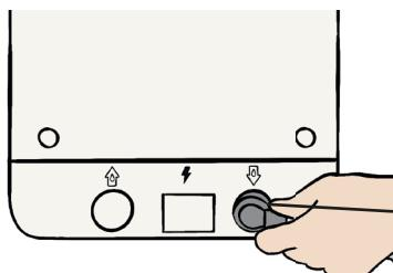
Conekte a mangueira de drenagem fornecida (1,5 m) ao seu Bob usando a abraçadeira da mangueira para garantir a estanqueidade.
