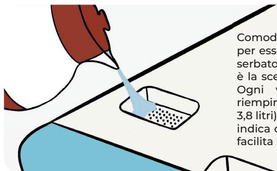
Comodo, rende Bob completamente autonoma per essere utilizzata ovunque ci si trovi. Riempire il serbatoio in pochi secondi con una caraffa. Questa è la scelta migliore se non si ha accesso all'acqua. Ogni volta che si utilizza l'elettrodomestico, riempire completamente il serbatoio (capacità 3,8 litri) finché non si sente un segnale acustico che indica che è pieno. Lasciando lo sportello aperto si facilita il riempimento.
