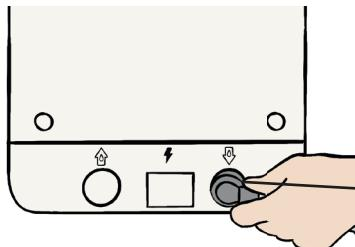
Sluit de meegeleverde afvoerslang (1,5 m) aan op uw Bob met behulp van de slangklem om de afdichting vast te zetten.
