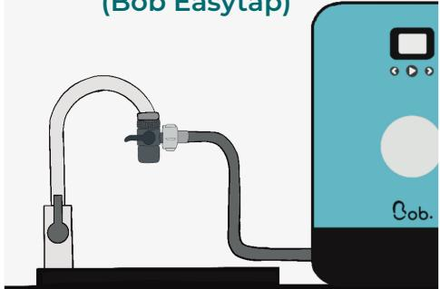
Met een Bob Easywater toevoerslang of een gelijkwaardige slang. Het vullen van de tank gebeurt dan automatisch aan het begin van elke cyclus.
