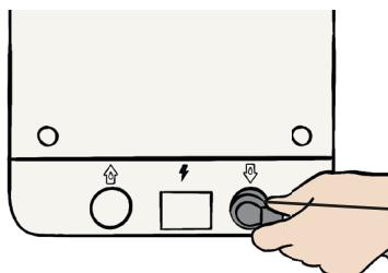
Podłącz dostarczony w zestawie wąż spustowy (1,5 m) do Boba za pomocą zacisku węża zapewniającego szczelność.
