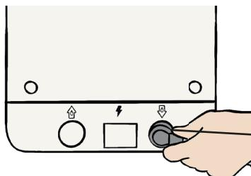
Collega a Bob il tubo di scarico in dotazione (1,5 m) usando il morsetto per garantire la tenuta.
