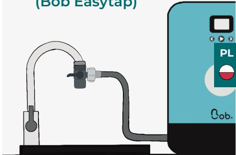
Zainstaluj Easytap Bob lub jego odpowiednik na kranie z dołączoną końcówką męską lub żeńską. Dźwignia urządzenia Bob Easytap umożliwia napełnienie urządzenia Boba lub używanie kranu.
