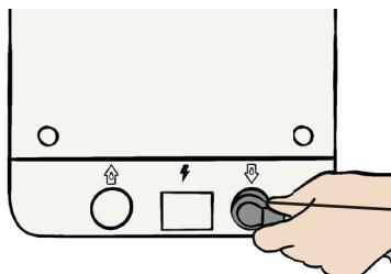
Anslut den medföljande dräneringsslangen (1,5 m) till Bob med slangklämman för att säkerställa en tätnings.
