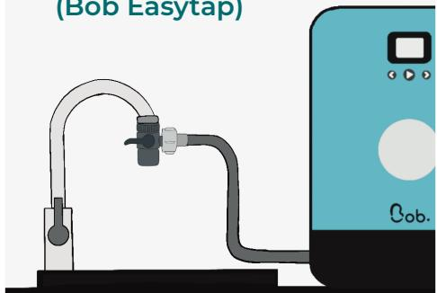
Avec un tuyau d'arrivée d'eau Bob Easywater ou un équivalent. Le remplissage du réservoir sera alors automatique au début de chaque cycle.
