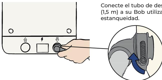
Conecte el tubo de desagüe que se incluye en el embalaje (1,5 m) a su Bob utilizando la abrazadera para asegurar la estanqueidad.
