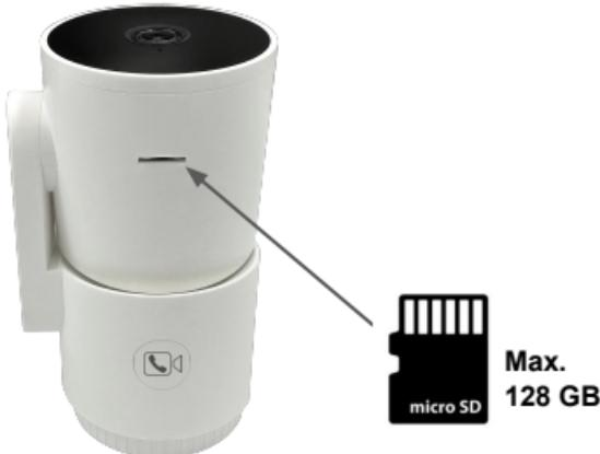
**FR** · En cas de détection de mouvement, la caméra enregistre automatiquement un clip vidéo. Ce clip peut être stocké localement sur une carte Micro SD ou bien en ligne avec notre service de stockage Cloud
