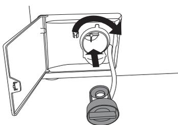
**6** Remettez le filtre en place comme indiqué sur la figure, en le tournant dans le sens des aiguilles d'une montre. Pour assurer l'étanchéité, la surface du joint doit être exempte de souillures. Remettez en place le tube de vidange.
