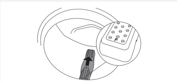
**5** Placez l'aube dans le trou repéré par la lettre F en face de vous. Vérifiez que toutes les aubes sont installées solidement dans leurs emplacements respectifs. Poussez l'aube vers l'arrière (comme indiqué par la flèche sur la figure) jusqu'à ce qu'elle se bloque.
